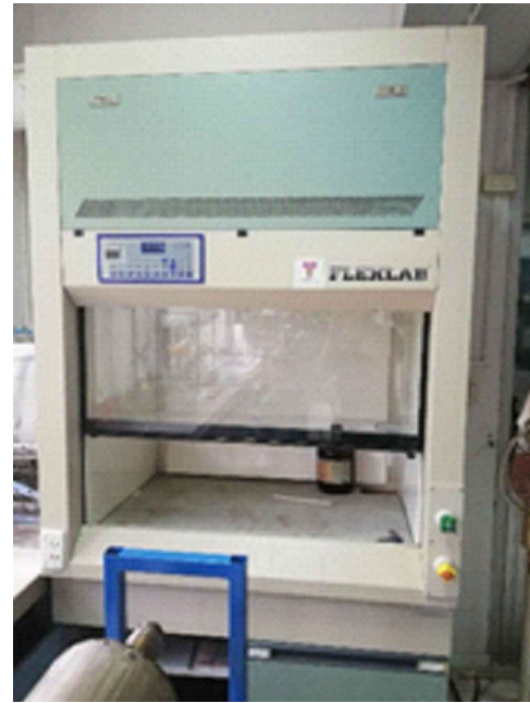
ตู้ดูดควัน FH1 - ขนาด 0.91x1.20x2.29 ม. จำนวน 1 ตู้
