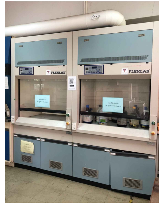
ตู้ดูดควัน (FLEXLAB) FH120 - ขนาด 0.91x1.20x2.29 ม. จำนวน 2 ตู้
